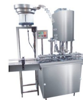
YQZ-1 Capper (sport cap) 自動鎖蓋機（運動蓋）
